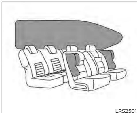
Sistema de bolsas de aire complementarias para impactos laterales instaladas en el asiento delantero y sistema de bolsas de aire complementarias para impactos laterales, tipo cortina, instaladas en el techo
