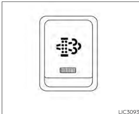
El interruptor del filtro de partículas diésel o interruptor DPF se puede utilizar para iniciar el proceso de regeneración del DPF. Este interruptor se iluminará cuando se ilumina la luz de advertencia del DPF. Esto le indica al conductor que se han acumulado partículas en el filtro y que no se pueden quemar automáticamente. Para obtener información adicional, consulte "Luz de advertencia del filtro de partículas diésel (DPF)" (P. 2-16).
